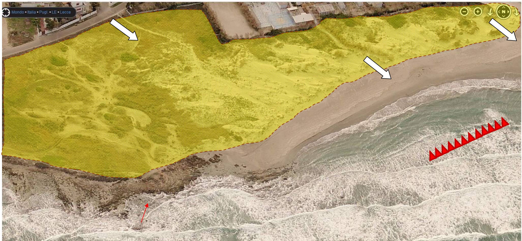
Figura 48 – Il substrato roccioso calcarenitico che affiora localmente lungo costa e sul quale appoggiano i depositi sabbiosi (mobili e mobilizzabili) del corpo dunale
