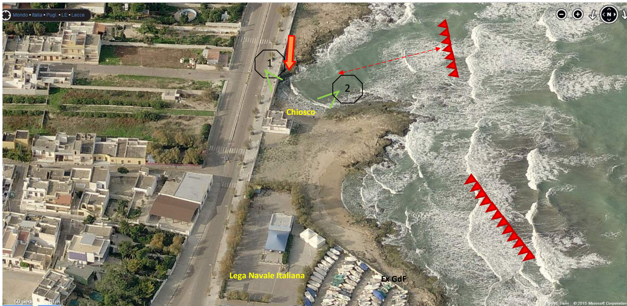
Figura 11 - 1° focus erosivo - La costa bassa interessata da fratture e disarticolazioni del substrato roccioso, spesso causate da interventi impropri eseguiti da privati che sbancano la scogliera al fine di realizzare un comodo accesso a mare alle imbarcazioni private. La presente criticità geologica è connessa alla tangenza della infrastruttura con la linea di riva litorale; l'infrastruttura (bordo della sede stradale, carreggiata pedonale e muro lungomare parapetto), è stata interessata da svariati episodi di crollo recenti 2012-2013
