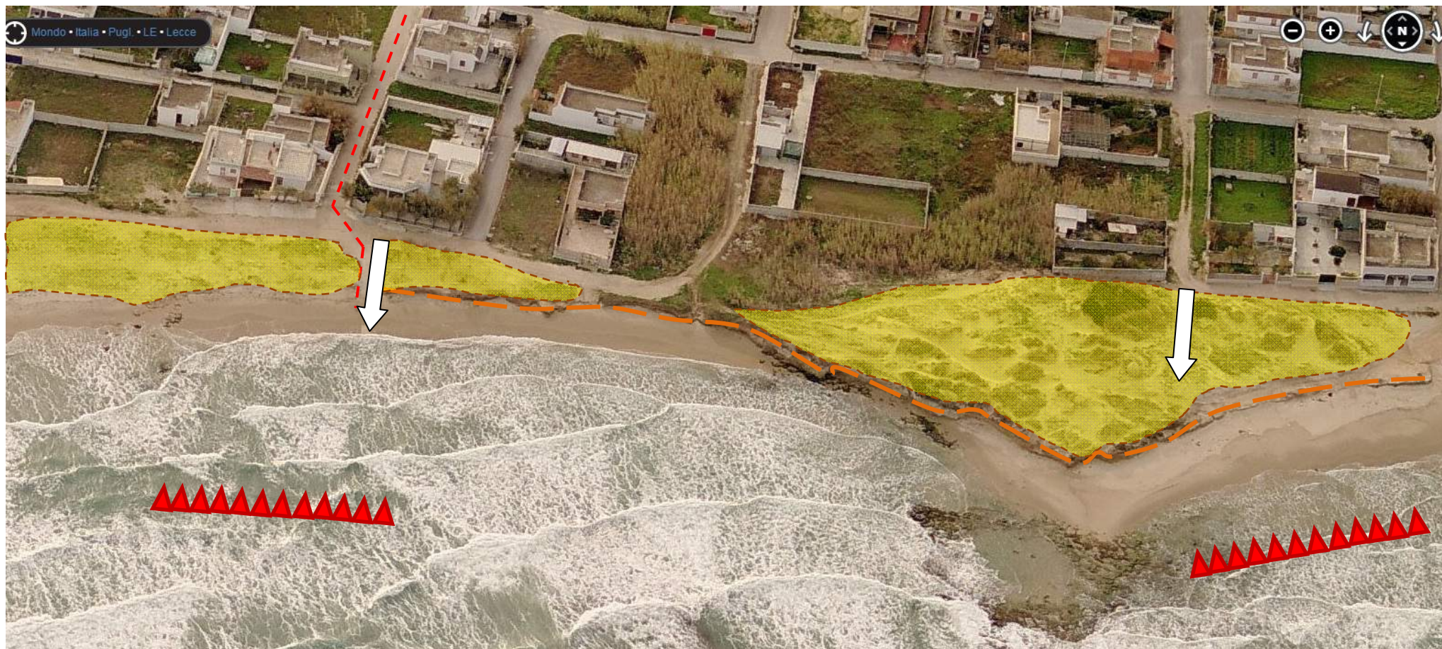
Figura 53 – il cordone dunale si assottiglia e sfuma sulla falesia bassa (<2 mt) a dx nella foto, intaccata al piede dal solco di battente; al tetto della falesia, ciò che resta dell'antico cordone dunale, relitto. Appare evidente lo stretto confinamento a tergo realizzato dagli edifici costituiti da 2 a case estive.
