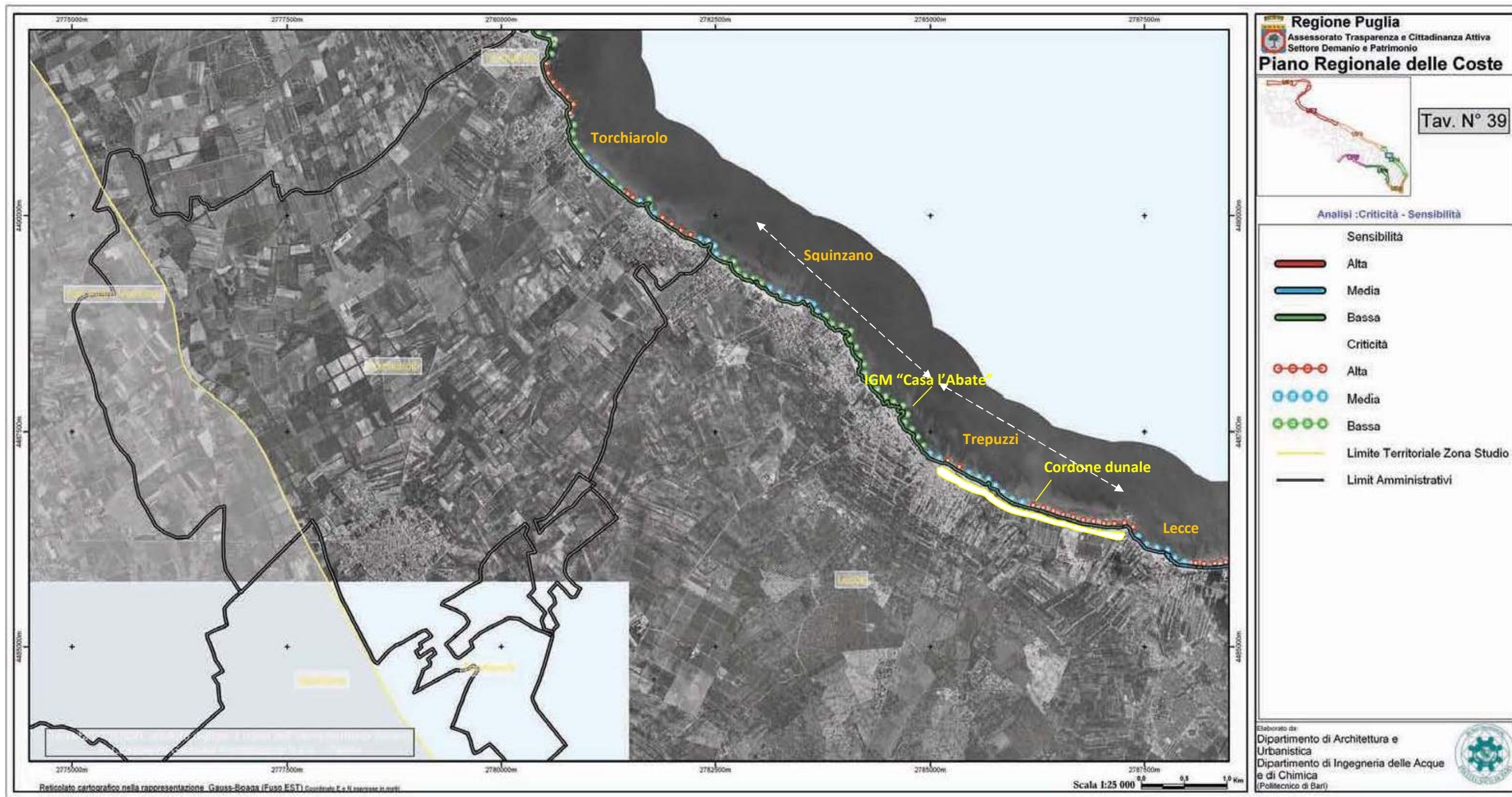
Figura 32 - Il documento cartografico ufficiale allegato al PRC "ANALISI: CRITICITA' – SENSIBILITA" , su BUR puglia n.31 del 29.02.2012 vol. III e, del quale si propone la modifica sia della Criticità (in riferimento al livello erosivo del cordone dunale) che della Sensibilità (in rifm. alla valenza ambientale e paesaggistica, appunto, del cordone dunale di cui all'IGM "posto dei trepuzzini").
