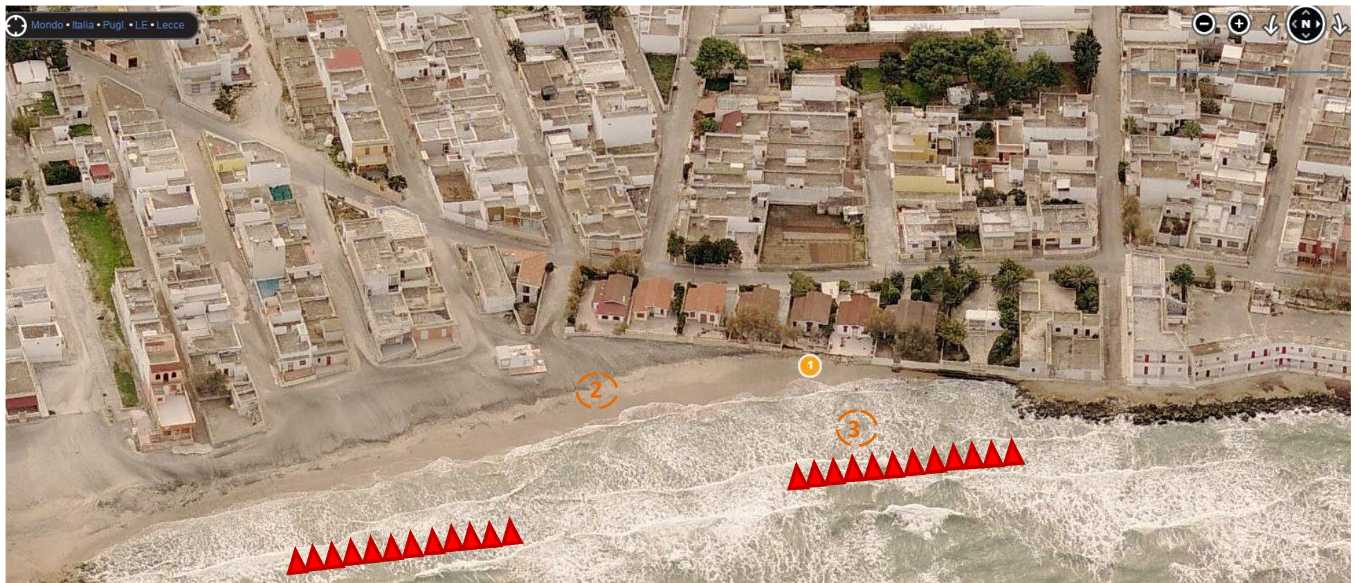
Figura 15 - 5° focus erosivo : rilevata una sorgente costiera (1) e memoria storica recente (2010) di un sink-hole (2) sulla spiaggia emersa, poi tombato dalla evoluzione dinamica della spiaggia; la spiaggia sommersa, ha visto formarsi un sink-hole (3) alimentato dal deflusso della falda (sorgente sottomarina)
