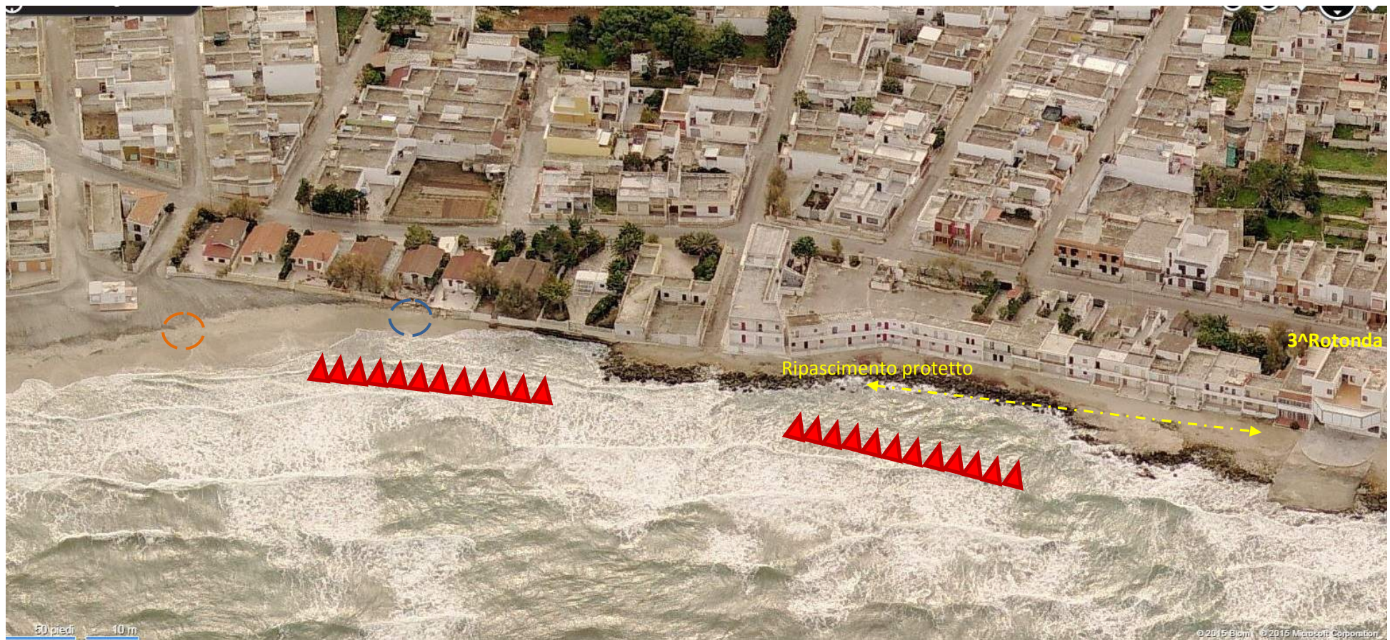
Figura 13 - 4° e 5° focus erosivi; è un tratto litorale specifico per le problematiche connesse, con un margine costiero geologicamente in evoluzione per la presenza di una sorgente costiera e per la ricorrenza di forme paracarsiche sink-hole; queste, dopo un certo periodo, vengono obliterate dalla evoluzione dinamica di spiaggia
