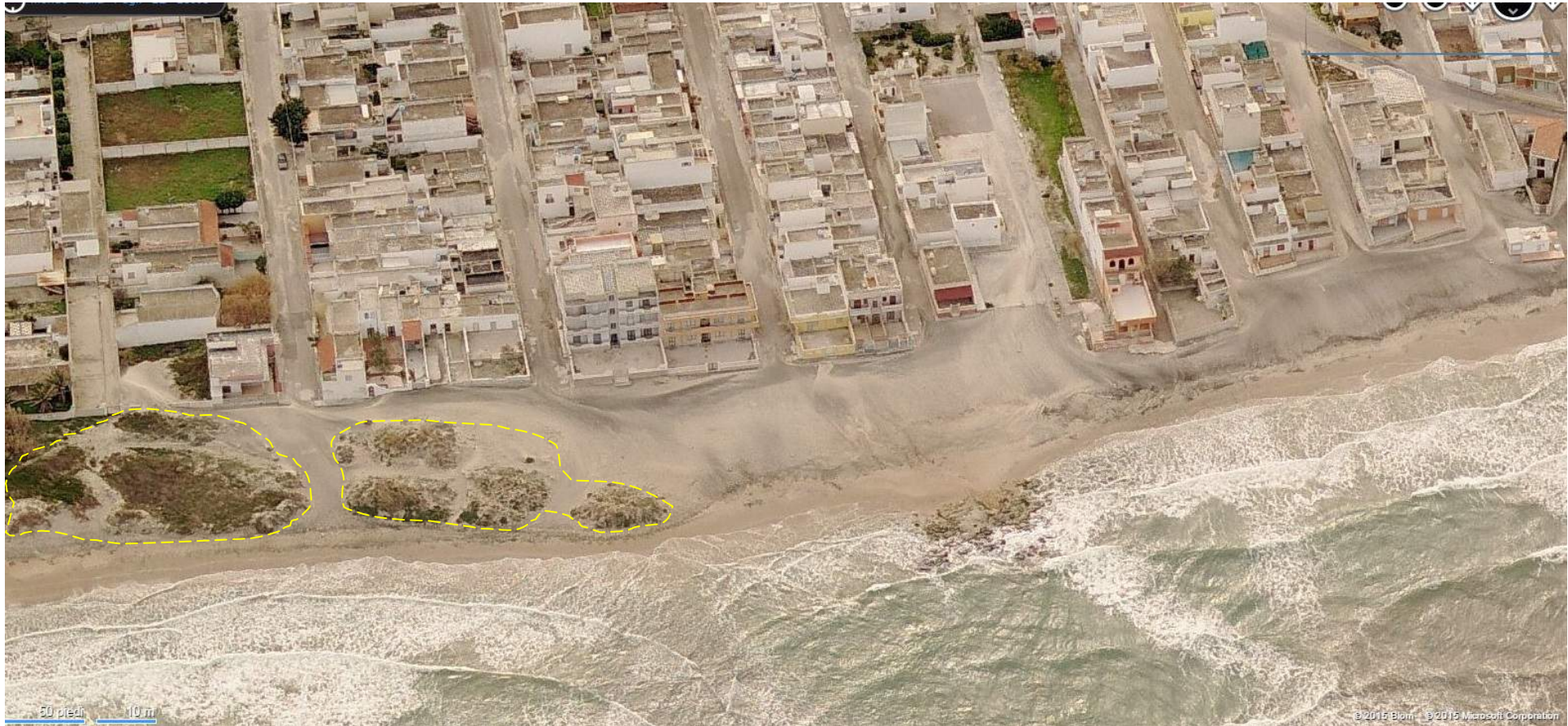
Figura 16 - 6° focus erosivo : limite nord del cordone dunale; i limiti di tale focus coincidono con quelli dello sviluppo del cordone dunale (ca.2200 m). La forma eolica costiera è in incipiente erosione fino al limite sud (IGM “T.re Rinalda”)
